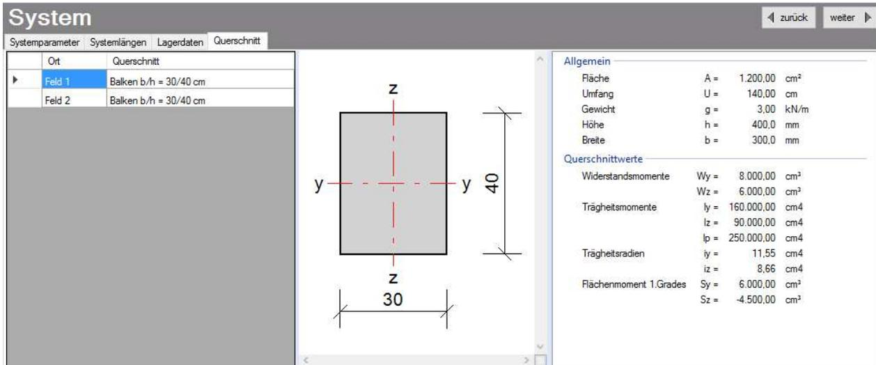
Im folgenden Querschnittsdialog kann die Bauteilform zwischen Rechteck- und Plattenbalken erfasst werden. Die statischen Querschnittsdaten werden ermittelt und angezeigt.
