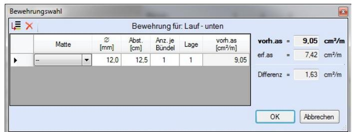
Die Bemessung erfolgt mit der automatisch ermittelten statischen Höhe  $d = h - \text{gew.d1}$ .
